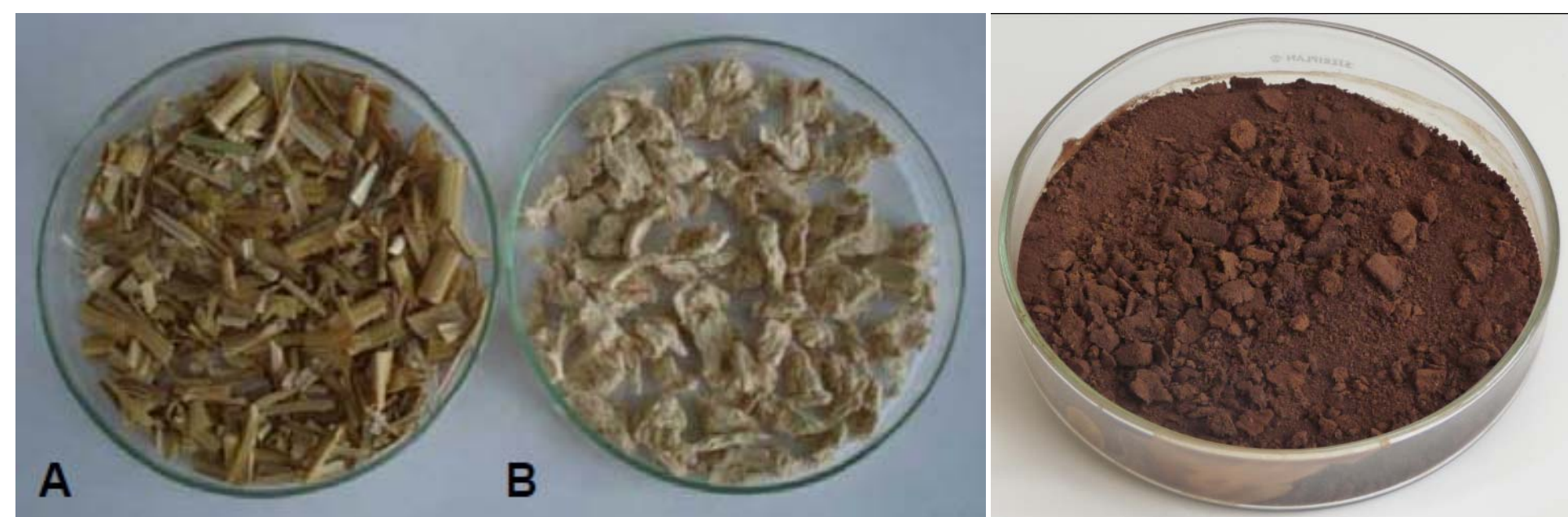
Unbehandeltes Stroh (A), nach dem NP-Verfahren aufgeschlossenes Stroh (B) Lignin nach dem NP-Verfahren aus Stroh gewonnen (C)
